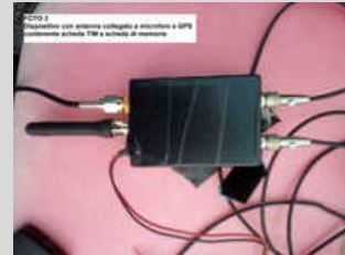
le dispositif avec antenne relié à micros et GPS. Il contenait aussi une SIM et une carte mémoire.
