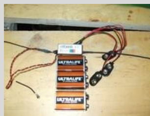
L'ensemble démonté. Les piles étaient déchargées.
